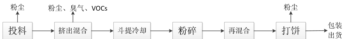
图3.4-1 环氧塑封成型材料生产工艺流程图
